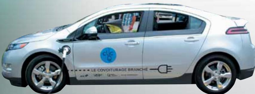
La charge s'effectue en 10 heures à l'aide d'une prise de courant domestique de 120 V ou en 4 heures aux bornes des terminus.
