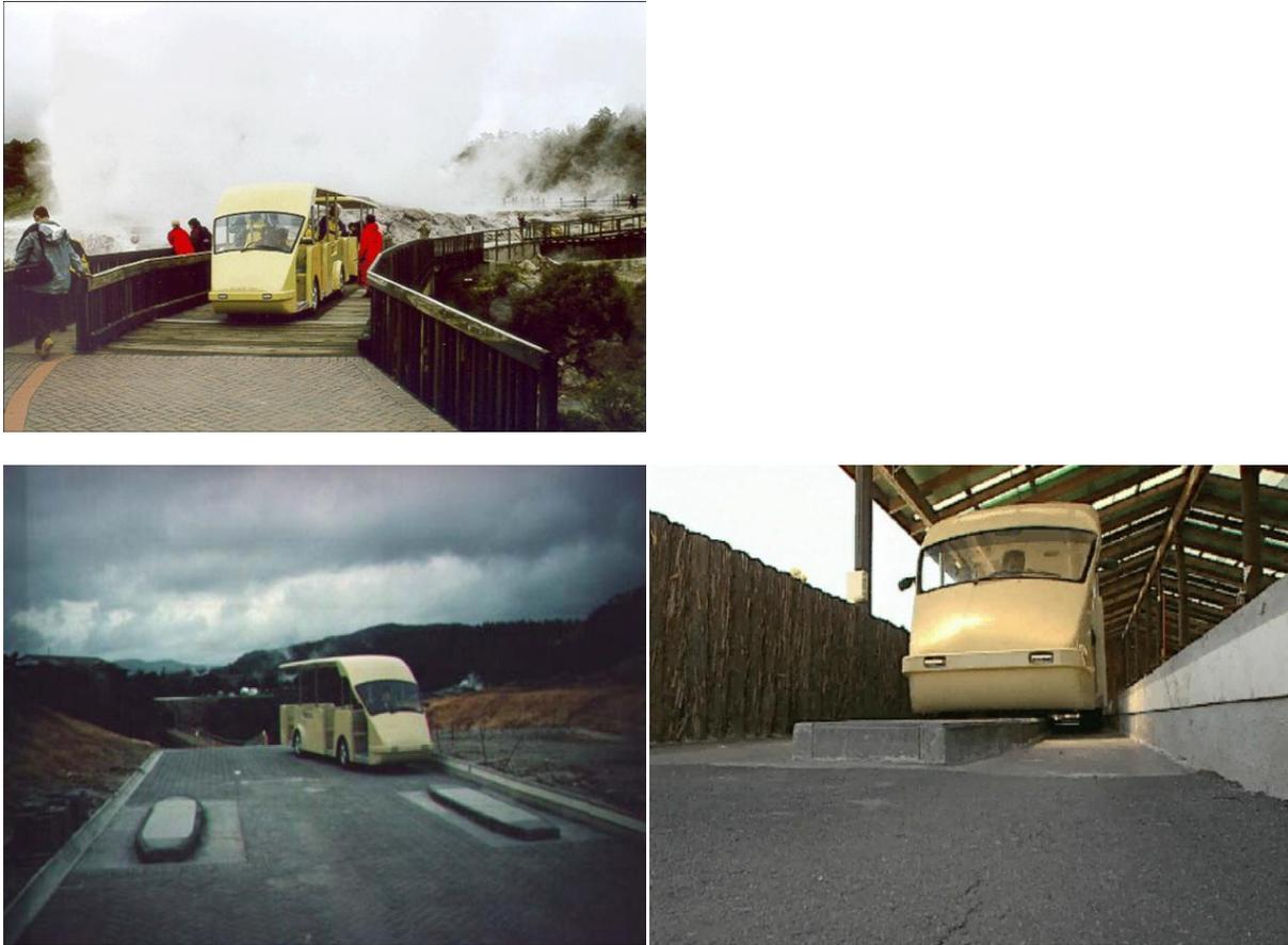
Figure 17, véhicule à recharge par induction de 20kW à Whakarewarewa
