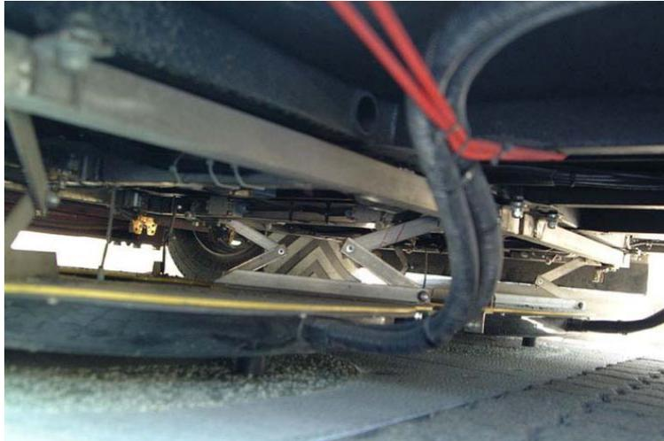
Figure 19, bobine mobile secondaire sous le bus, Gênes
