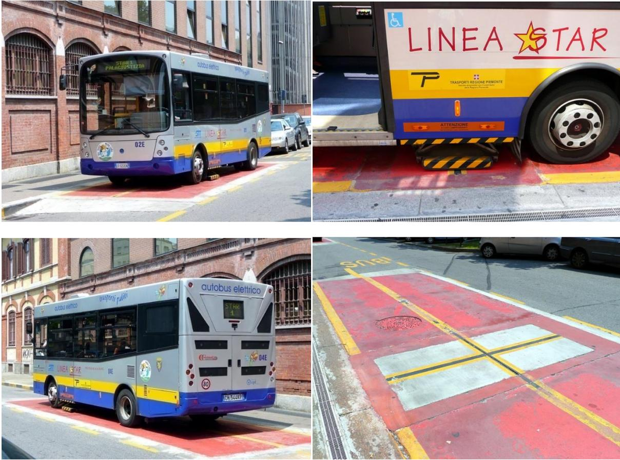
Figure 20, bus italien Elfo à recharge inductive
